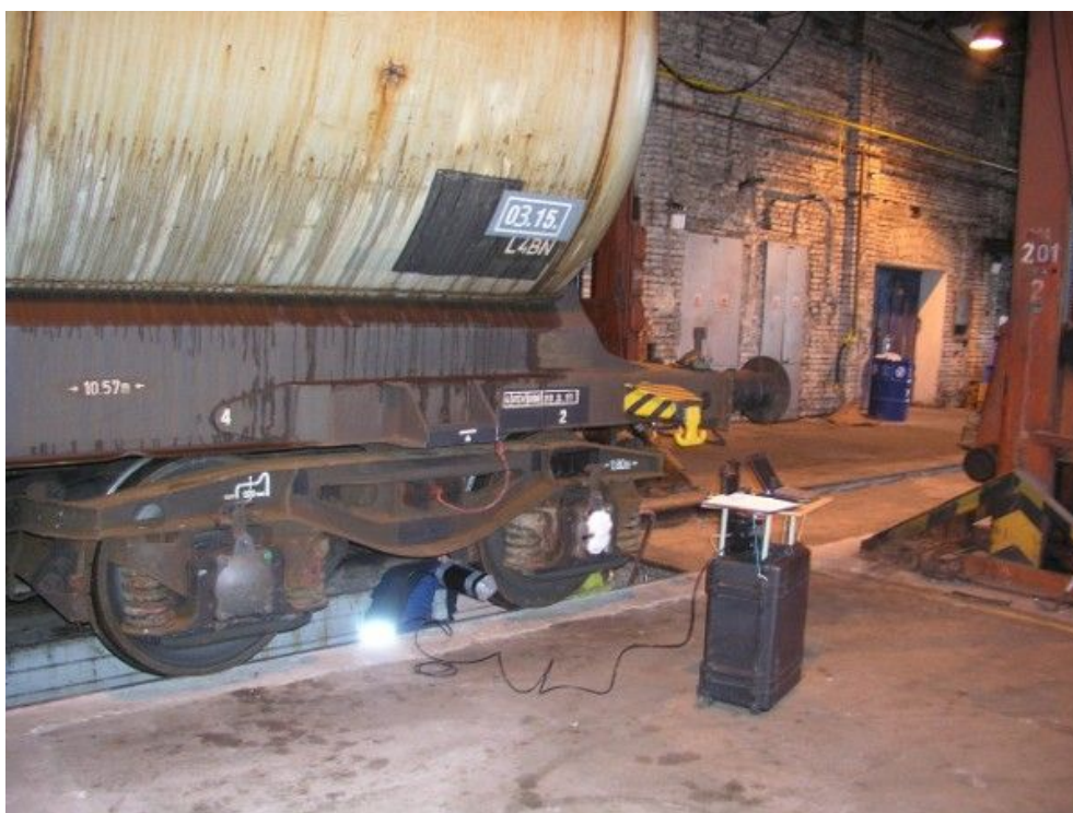
Foto 3: Snímek dokumentující měření jízdních obrysů kol dvojkolí TDV Zas řazeného jako 11. TDV za HDV
