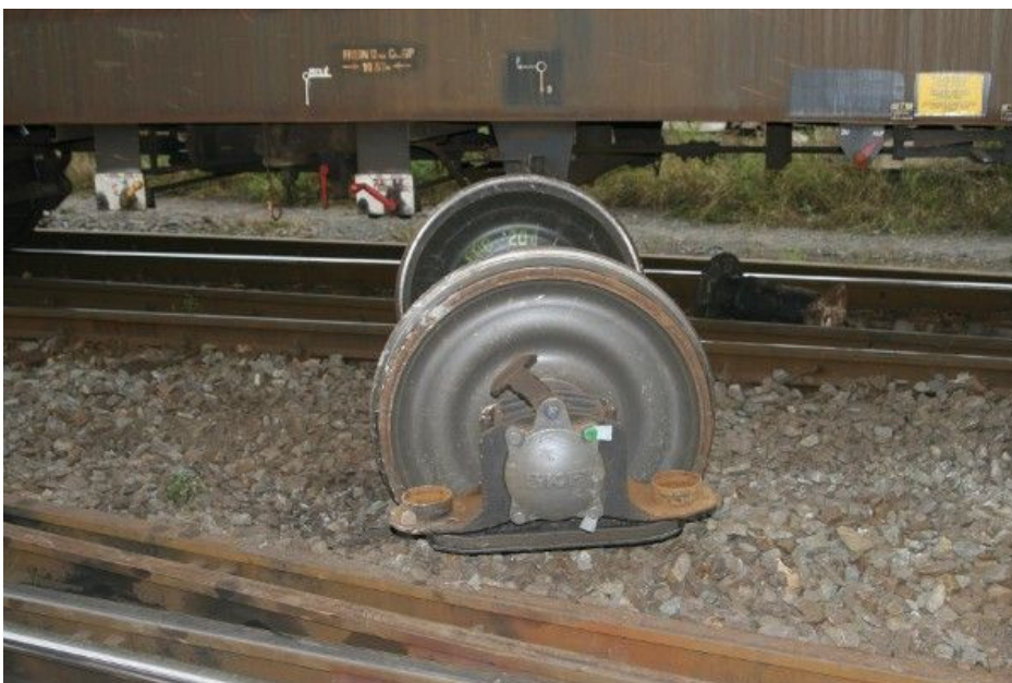
Foto 2: Vypadlé 2. dvojkolí zadního podvozku TDV Zas řazeného jako 11. TDV za HDV vlaku Vn 48221 po vzniku MU
