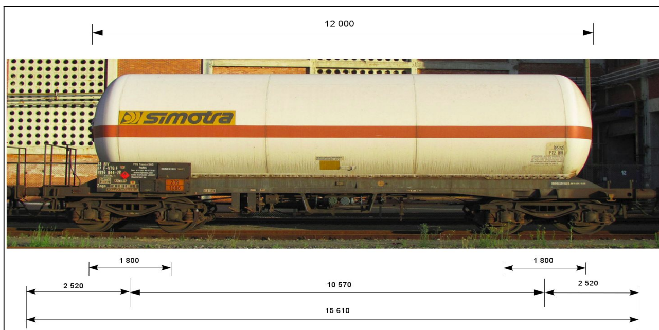
Obrázek č. 2: Orientační bokorys TDV Zas typu 365 se základními rozměrovými parametry.
