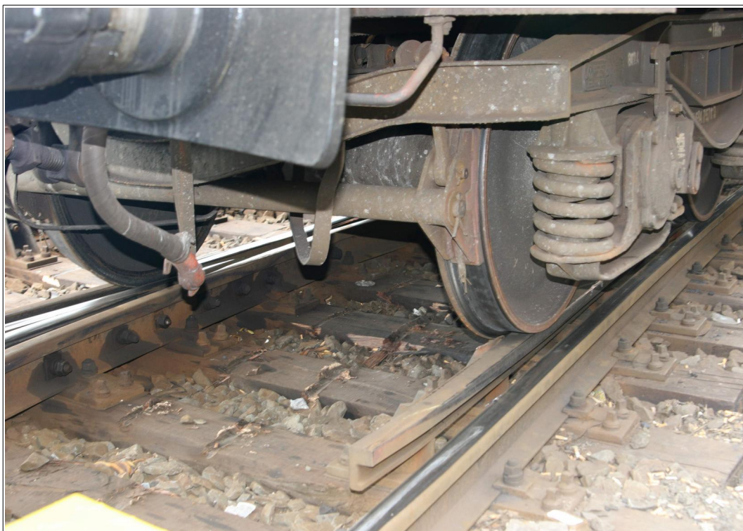
Obr. č. 5: Pohled na vykolejenou 1. nápravu TDV Eas-u 31 54 5947 571-3
