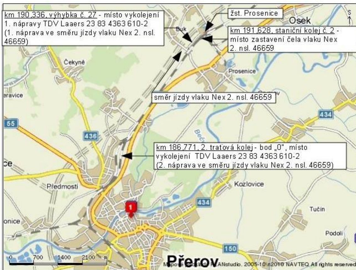
Obr. 2 Popis jízdy vlaku Nex 2. nsl. 46659 v traťovém úseku mezi žst. Přerov a Prosenice, vč. sledu událostí.
