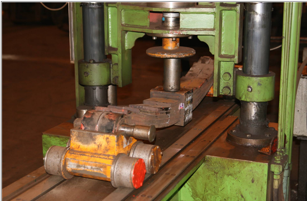
Obr. 6 Snímek ze dne 10. 03. 2011 dokumentující zkoušku poddajnosti trapézové pružnice č. 5 TDV Laaers 23 83 4363 610-2, prováděnou na kalibrovaném stavu ČD Cargo, a. s., SOKV Ústí nad Labem.
