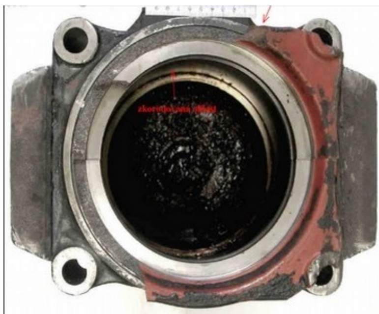
Obr. č. 7: Oblast napadená korozí
