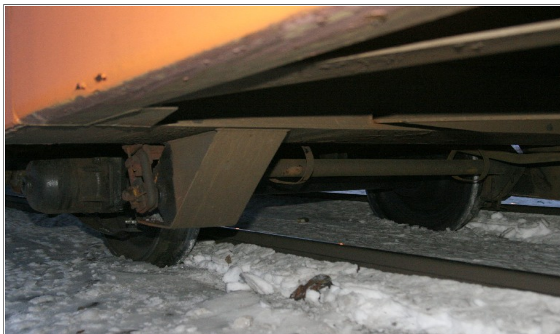
Obr. 1, 2 Snímky dokumentující vykolejenou nápravu TDV Laekks 43 83 4254 362-8.
