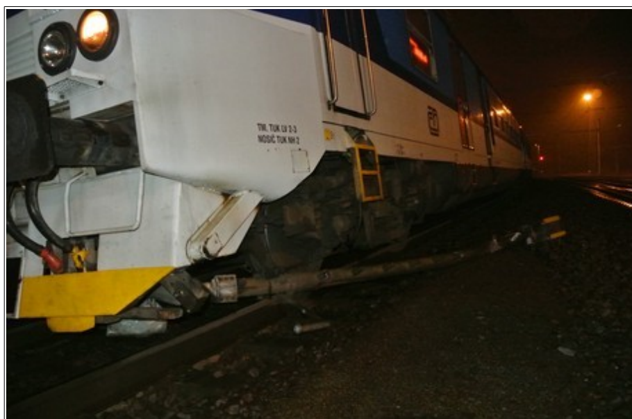
Obr. č. 1: Pohled na konečné postavení vlaku Os 3333 po srážce s hlavním (odjezdovým) návěstidlem L1 žst. Prosenice
