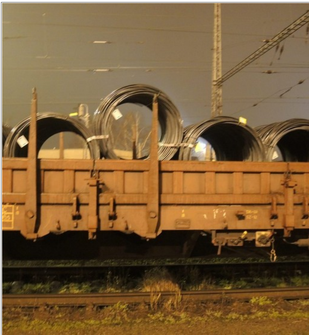
Obr. č. 5: Pohled na svitek válcovaného drátu ložený sedlaně, plnící funkci závěru vrstvy, uložený na TDV 31 54 3938 350-8
