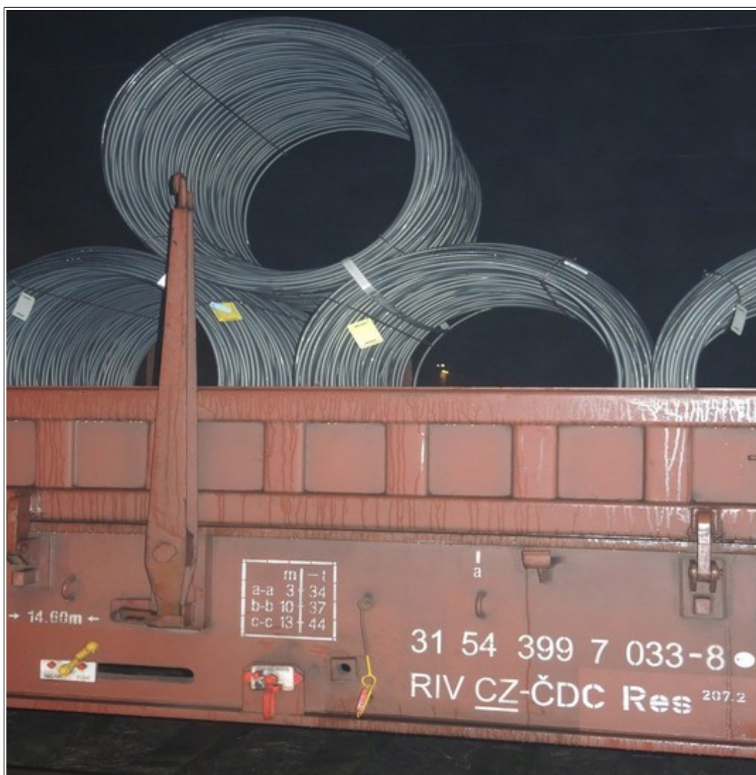
Obr. č. 6: Pohled na svitek válcovaného drátu ložený sedlaně, který neplní funkci závěru vrstvy, uložený na TDV 31 54 3997 033-8 Zdroj: DI
