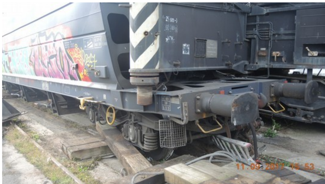
Obr. č. 5: Poškozený a vykolejený vůz 37 80 0764 544-3
