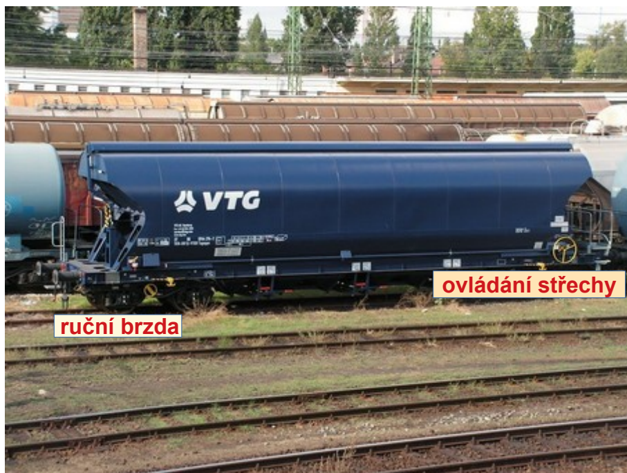
Obr. č. 3: Umístění ruční brzdy a ovládání střechy Zdroj: internet, upraveno DI
