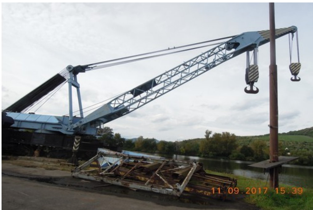
Obr. č. 4: Poškozený jeřáb EDK 2000
