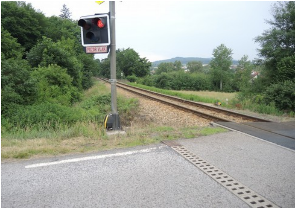
Obr. č. 4: Rozhledová délka ve směru jízdy OA a proti směru jízdy vlaku Os7909
