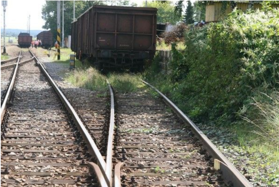
Foto č. 4: pohled na vegetaci v koleji a na vykolejená DV
