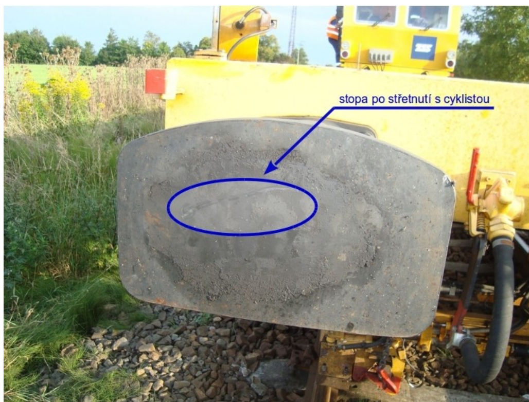
Obr. č. 4: Stopa po střetnutí na nárazníku SHDV
