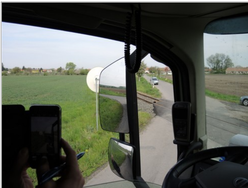
Obr. č. 3: Pohled z místa řidiče po zastavení NA před ŽP, kdy neměl dostatečný rozhled na trať vlevo.
