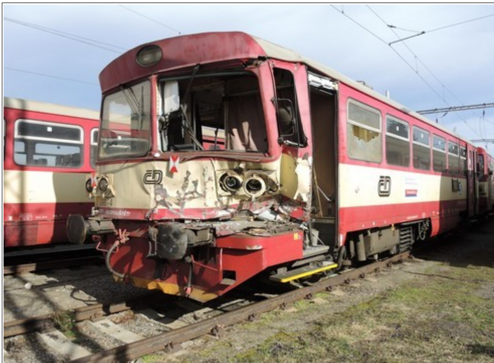
Obr. č. 5: Pohled na poškozené přední čelo HDV 810.098-4 po MU.
