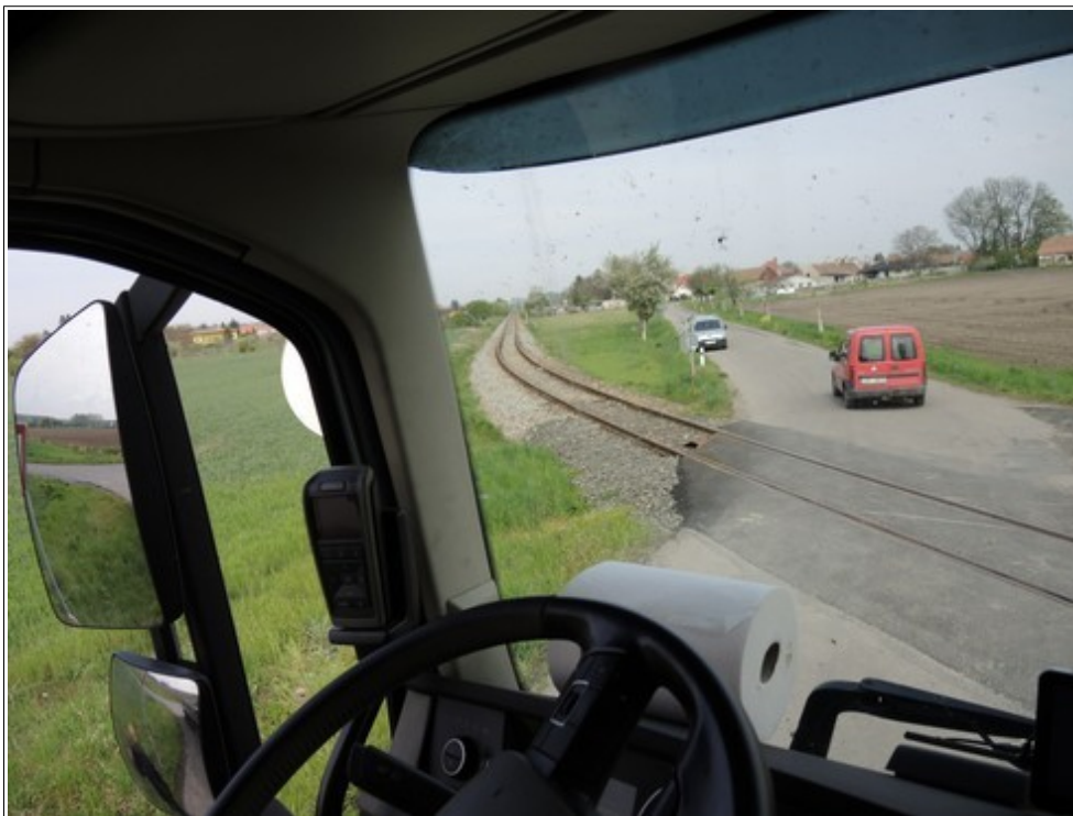
Obr. č. 4: Pohled z místa řidiče při správném zastavení NA tak, aby měl zajištěn dostatečný rozhled na trať (za levým předním sloupkem kabiny je patrný levý okraj dopravního zrcadla.
