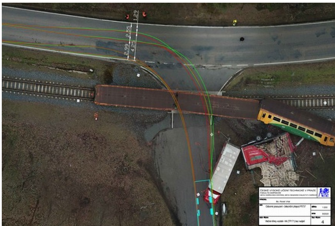
Obr. č. 19: Vlečné křivky jízdní soupravy s přívěsem zúčastněné na MU (s nadjetím a bez nadjetí)
