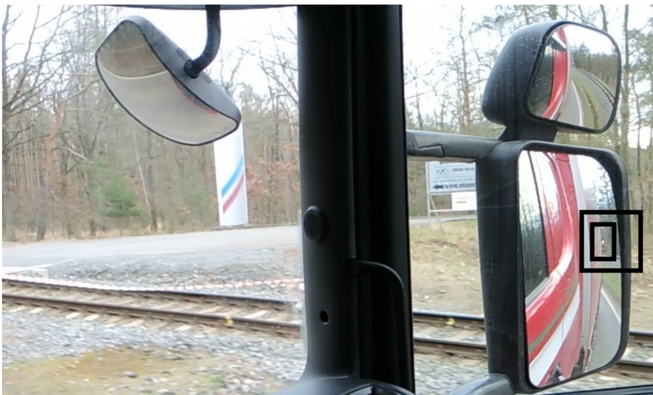
Obr. č. 12: Foto výhledu řidiče NA na trať (vlak) ve zpětném zrcátku při ověření viditelnosti, kdy se vlak na okamžik téměř ztratil z výhledu při najetí NA doleva pro následné odbočení vpravo
