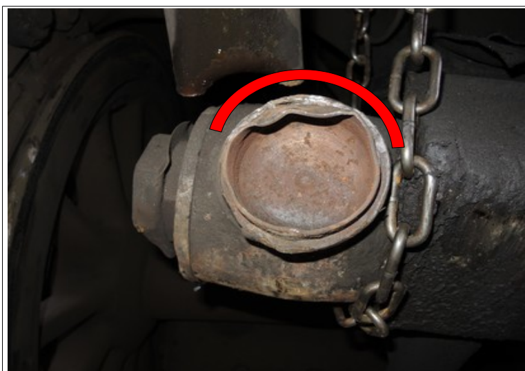
Obr. č. 9: Vyznačení čerstvého lomu – dolomení šikmé tyče
