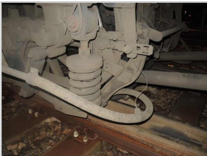
Obr. č. 1: Pohled na vykolejenou nápravu zadního podvozku Zdroj: DI
