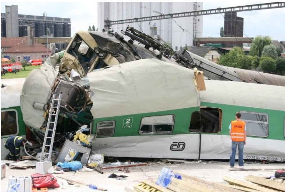
Obrázek 1: Pohled na zaklínění a destrukci HDV 151.018-9, 1. TDV a 3. TDV vlaku EC 108.
