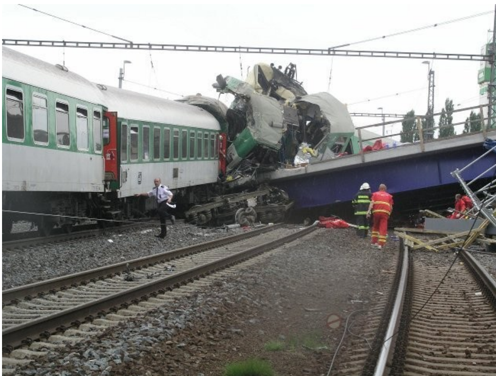
Obrázek 3: Pohled zprava ve směru jízdy vlaku EC 108 na destruktci TDV, zaklíněných o nosnou konstrukci zříceného mostu.
