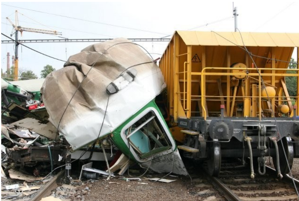
Obrázek 6: Pohled na destrukci TDV 50 54 20-38 009-7 vlaku EC 108, zaklíněného do TDV 80 54 2800 313-3 vlaku 1. nsl. Pn 60230.
