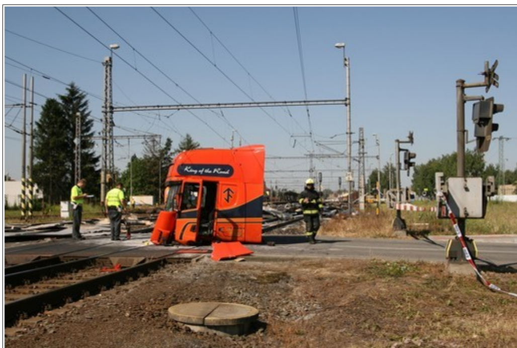
Obr. č. 7: Pohled na utrženou kabinu SMV po střetnutí s vlakem Ex 512.
