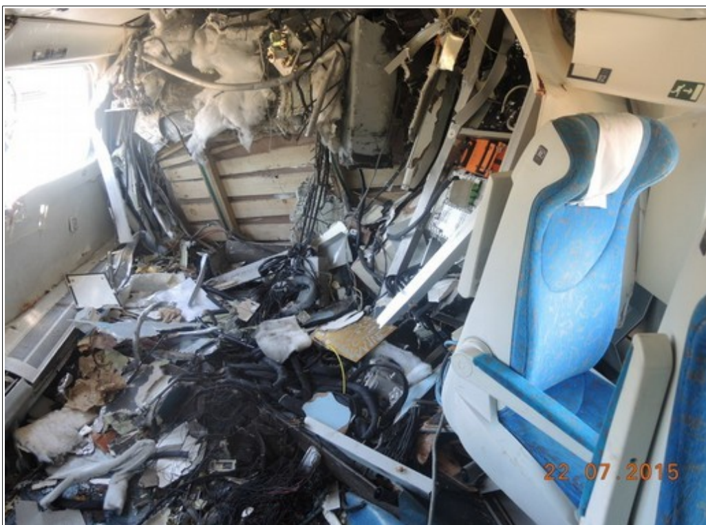
Obr. č. 12: Pohled na devastovaný interiér oddílu pro cestující v čele vlaku Ex 512 řazeného hlavového DV. Zdroj: DI
