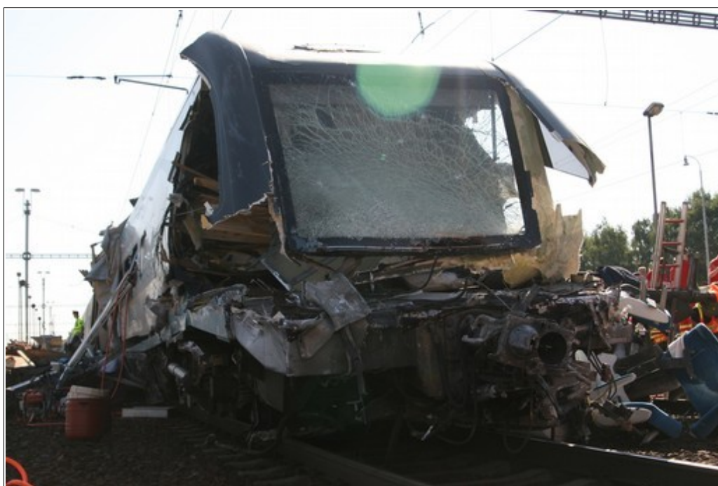
Obr. č. 10: Pohled na devastované čelo vlaku Ex 512 se zaklíněným SMV, vlevo torzo tahače SCANIA, vpravo torzo návěsu KRONE. Zdroj: DI
