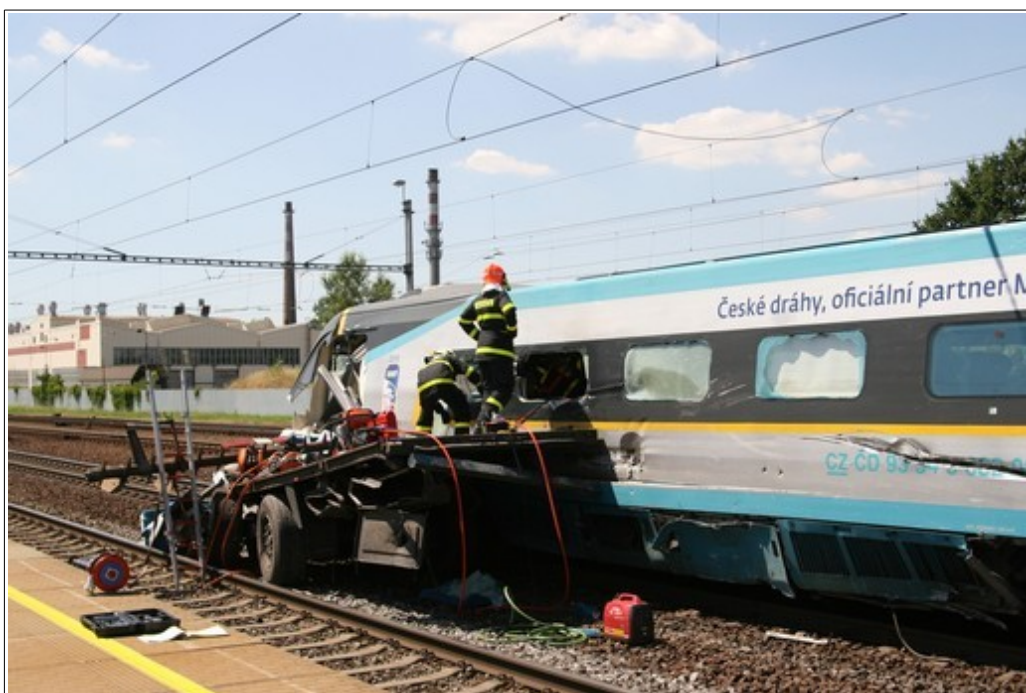
Obr. č. 11: Pohled na devastované čelo vlaku Ex 512 v místě zastavení vlaku po MU se zaklíněným SMV, torzem návěsu KRONE. Zdroj: DI
