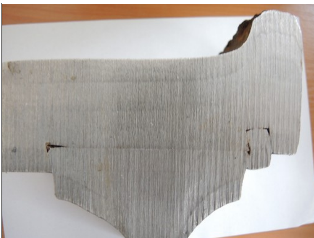
Obr. č. 8: Řez pravým obručovým kolem TDV 88 54 9200 105-6 se správným spojením obruče s kotoučem kola.
