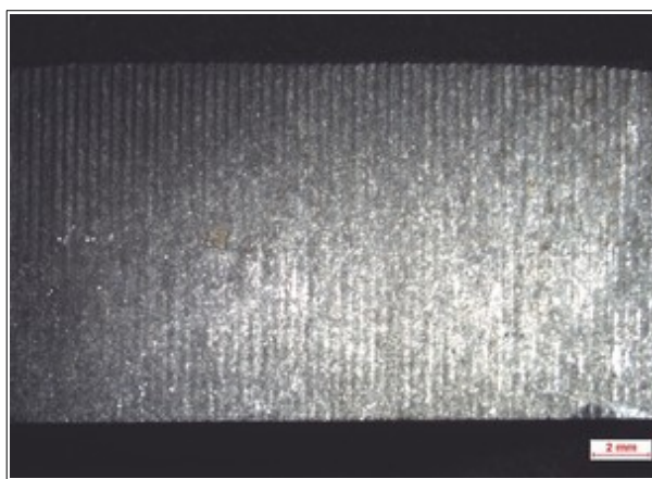
Obr. č. 5: Viditelné stopy na styčné ploše obruče po obrábění před „natažením“ obruče na kotouč pravého kola.
