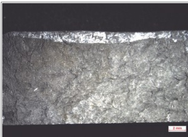
Obr. č. 4: Stopy plastické deformace na styčné ploše obruče levého kola.
