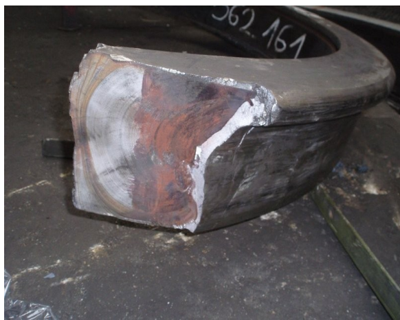
Obr. č. 4: Lom obruče - první část lomu.
