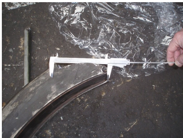
Obr. č. 3: Délka únavového lomu.
