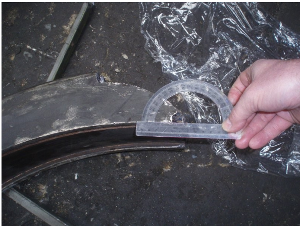
Obr. č. 2 : Úhel postupu únavového lomu.
