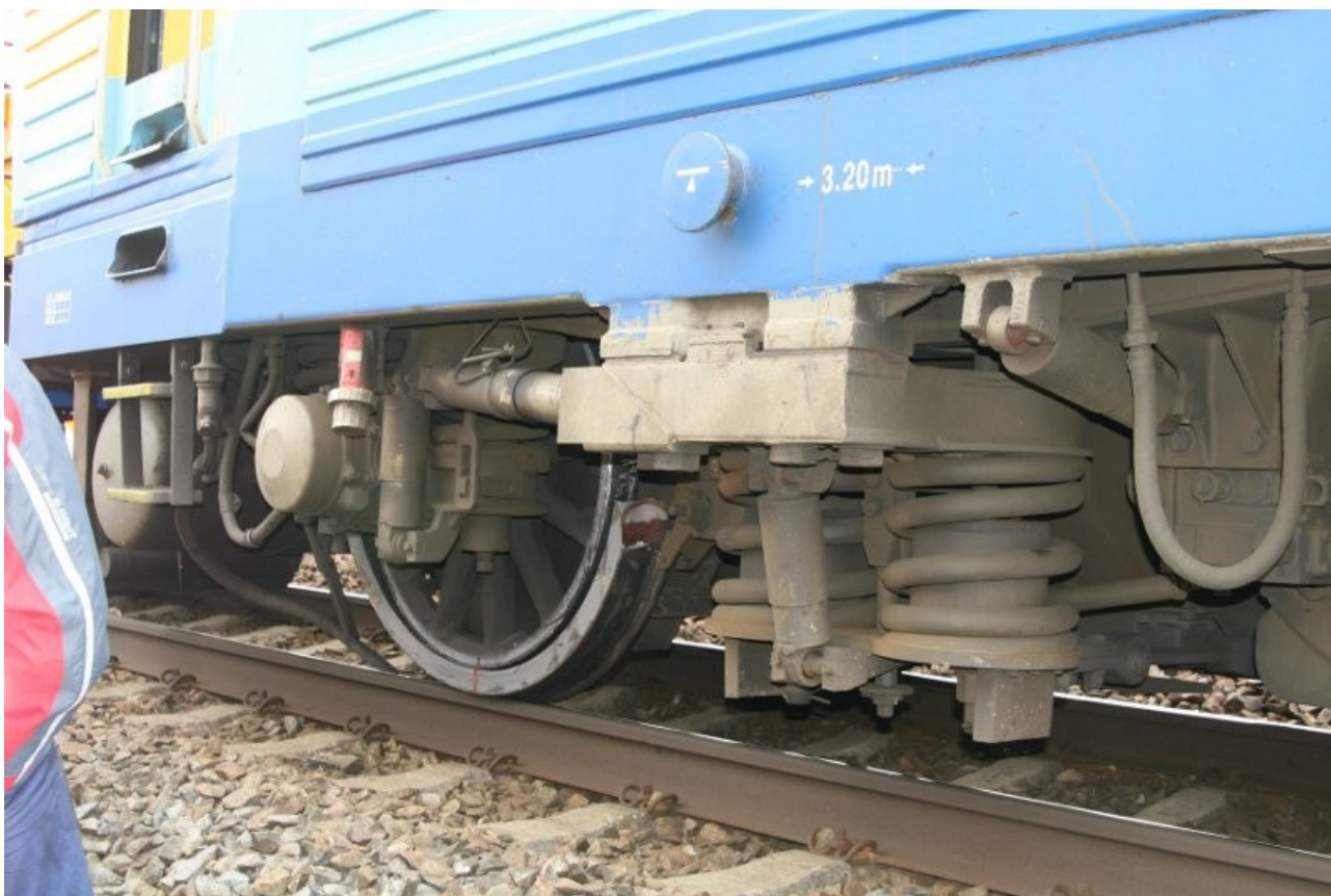
Foto 3: Lom obruče HDV 362.161-2
