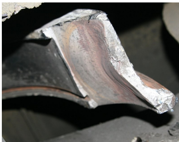
Obr. č. 5: Lom obruče - druhá část lomu.
