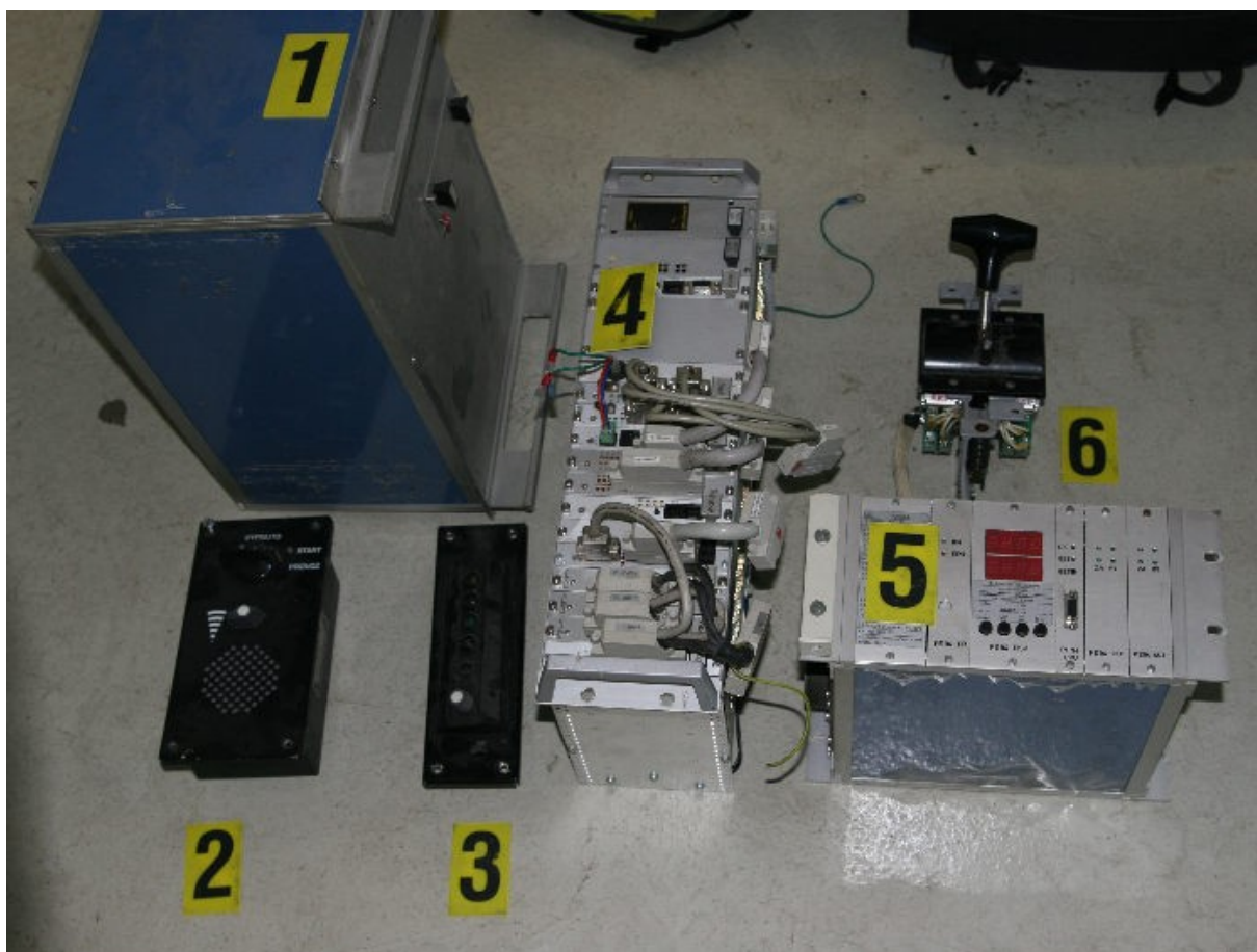
Foto 5: 1. skříň VZ; 2. ovládací skříňka VZ; 3. návěstní opakovač; 4. vozový počítač; 5. regulátor protismyku; 6. řídicí kontrolér.
