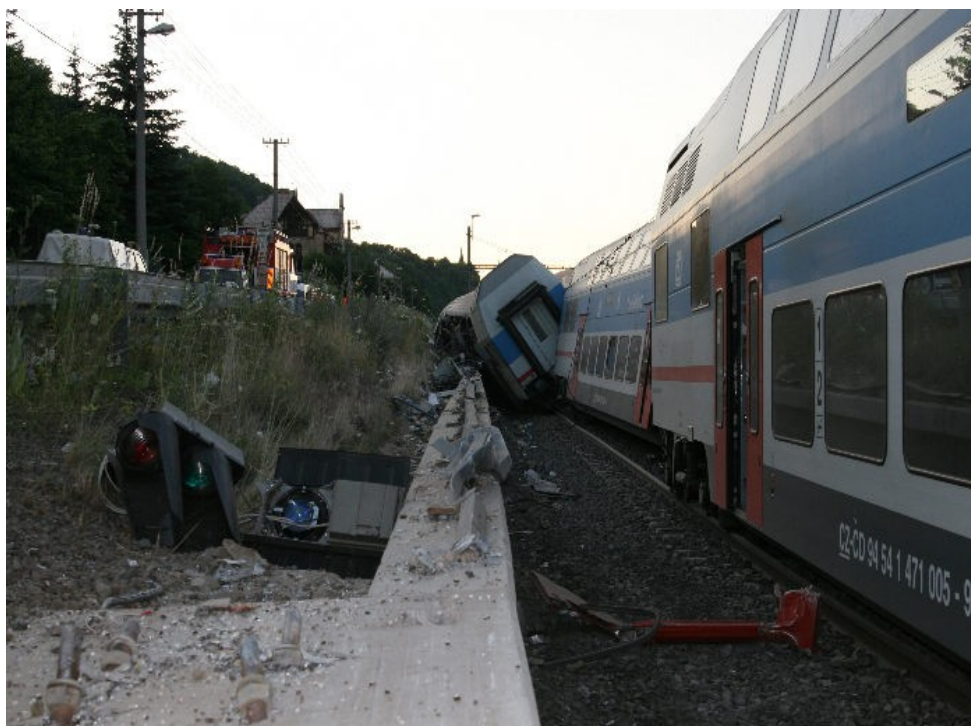
Foto 10: Opěrná zeď a části PZZ přejezdu č. P 2425
