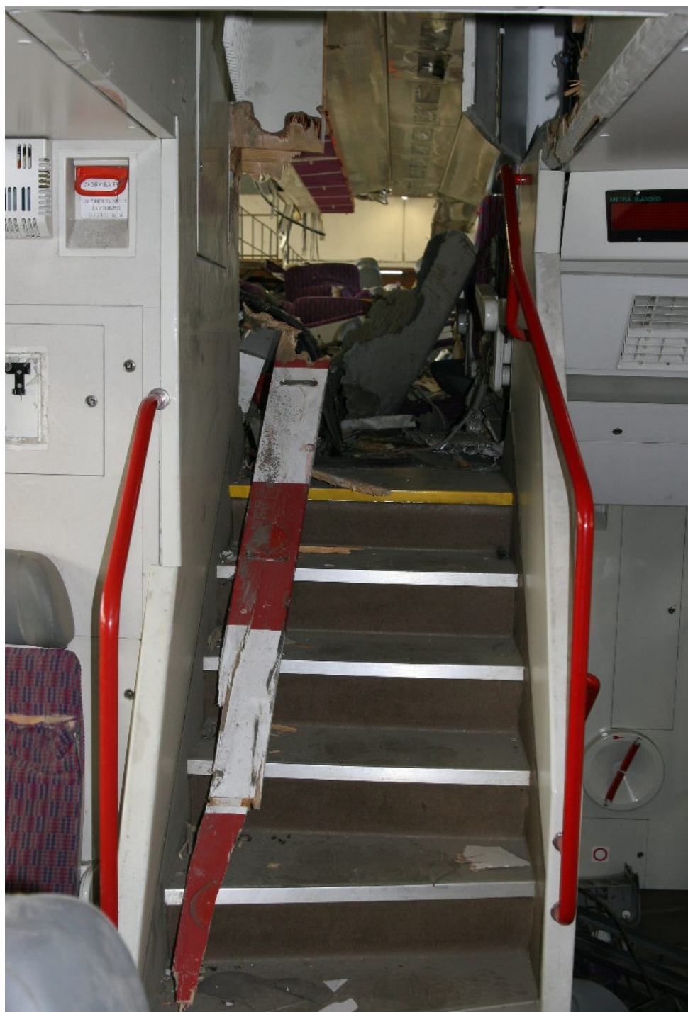
Foto 17: Závorové břevno přejezdu č. P 2425 zaklíněné v horní části oddílu pro cestující DV 971.005-4
