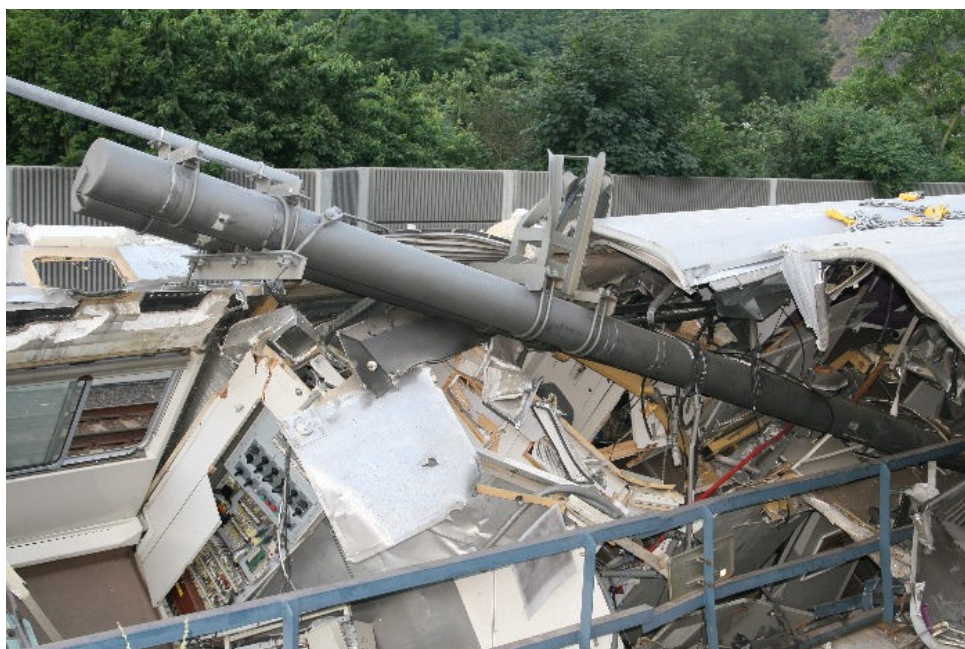
Foto 11: Sloup trakčního vedení zaklíněný v oddílu pro cestující DV 971.005-4
