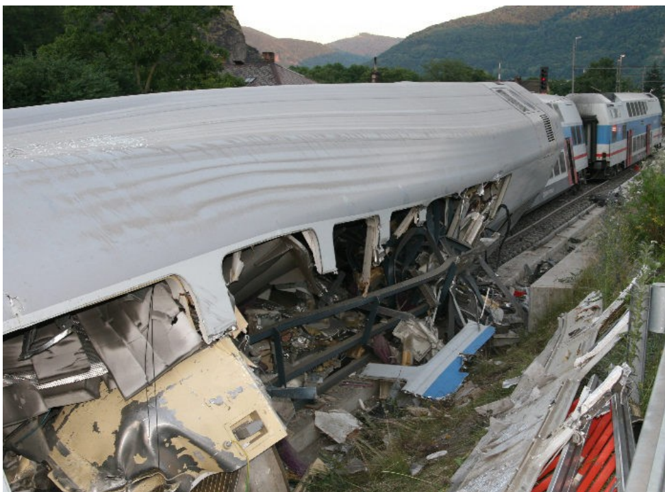
Foto 12: Deformovaný oddíl pro cestující v horní části DV 971.005-4
