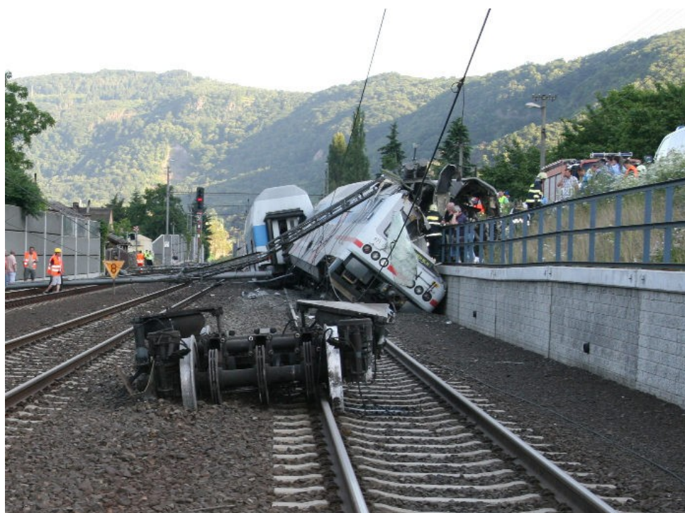
Foto 15: Pohled na podvozek DV 971.005-4 a čelo vykolejeného vlaku Os 2316 ze směru žst. Ústí nad Labem hl. n.
