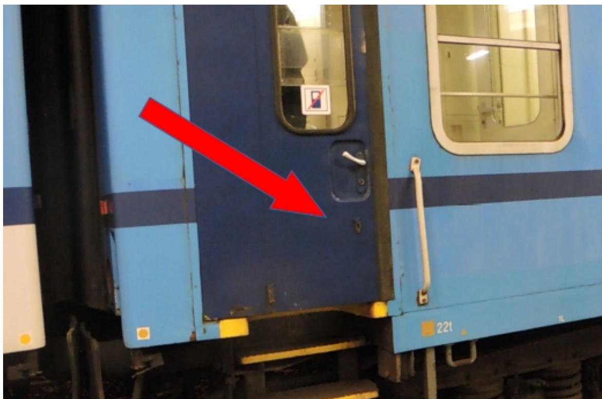
Obr. č. 18: Pohled na dveře vozu řady BDs, kde je viditelný zámek pro tzv. pětkový klíč Zdroj: DI
