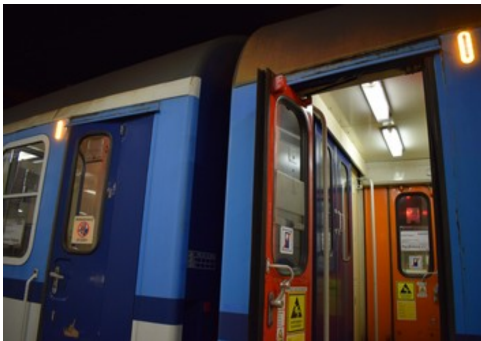
Obr. č. 12: Pohled na indikátory stavu nástupních dveří v noční době Zdroj: DI
