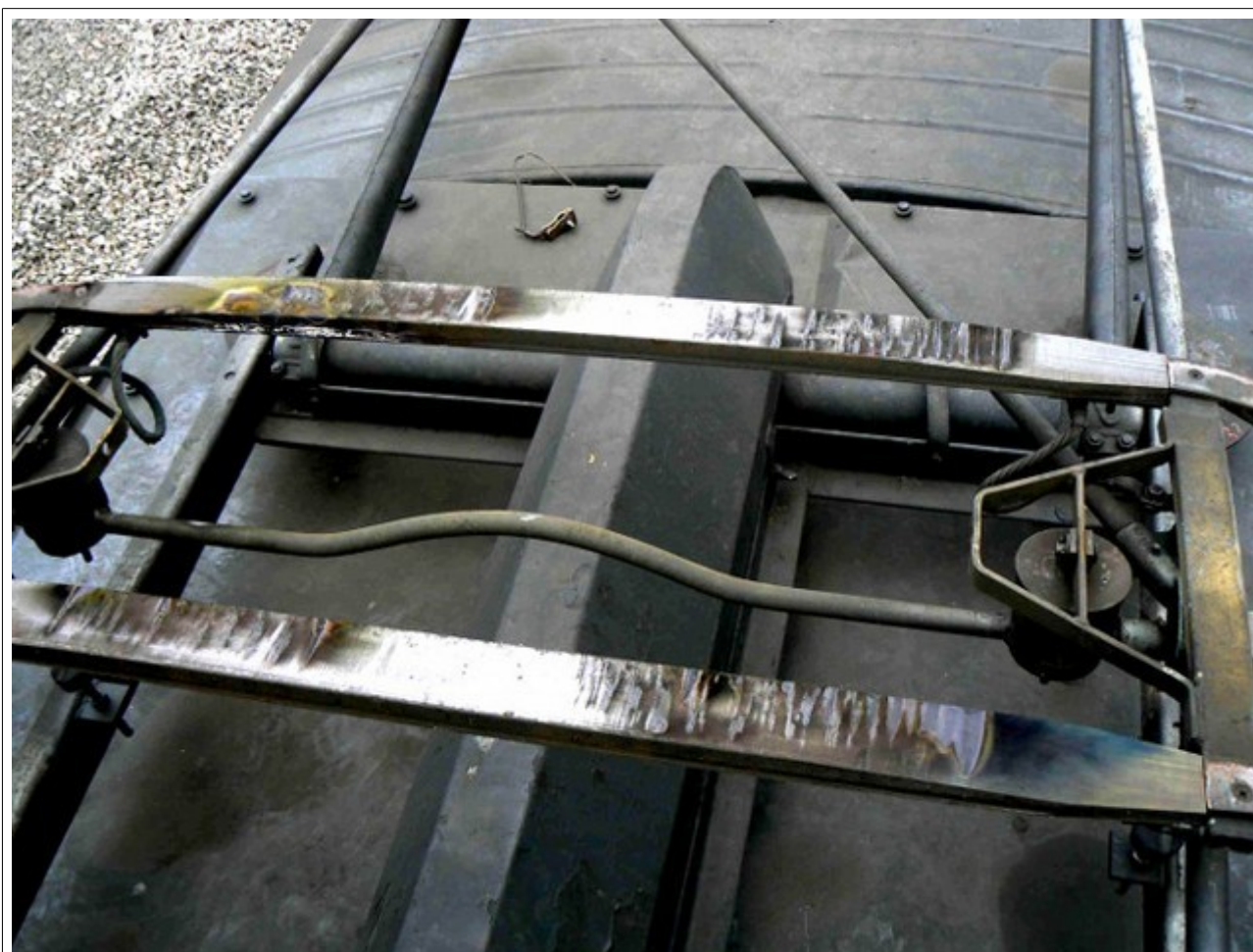
Obr. č. 10: Pohled na smýkadla aktivního sběrače HDV1
