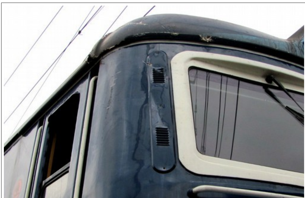
Obr. č. 13: Poškození čela HDV2
