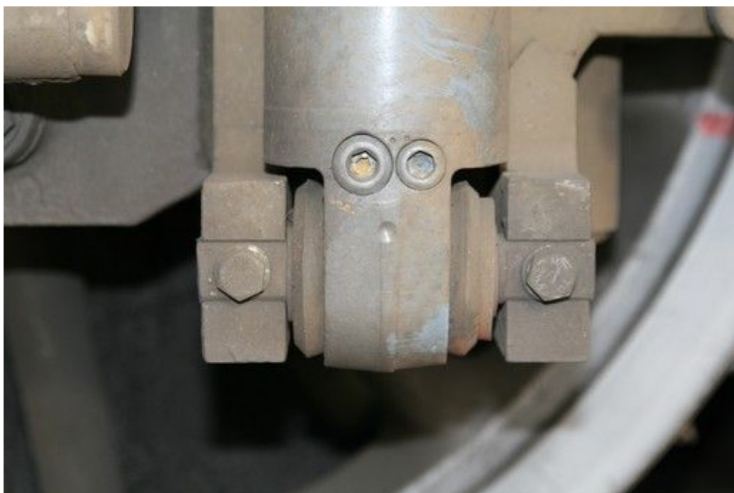
Obr. č. 12: Dolní konzole tlumiče a nosič sekundárního vypružení v nepoškozeném stavu
