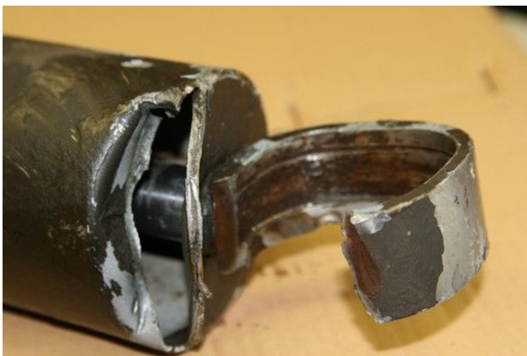
Obr. č. 8: Prasklé oko tlumiče sekundárního vypružení
