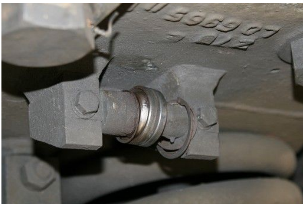
Obr. č. 6: Poškození horní konzole tlumiče
