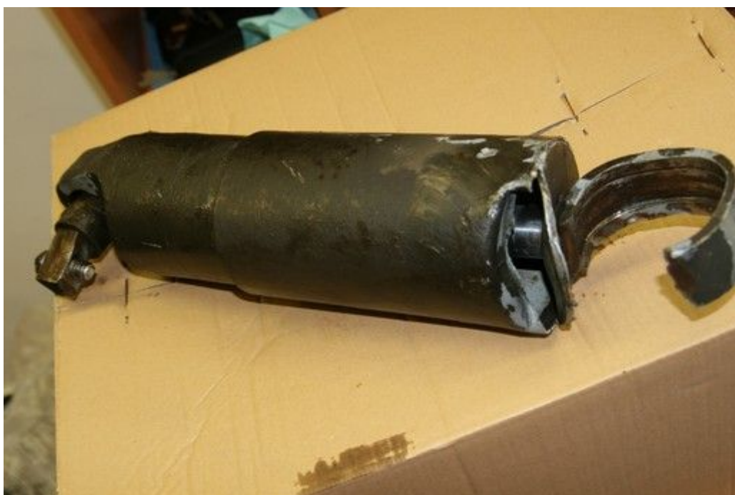
Obr. č. 7: Poškození tlumiče sekundárního vypružení
