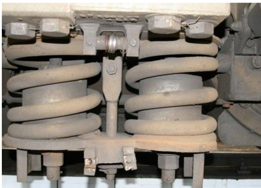
Obr. č. 4: Chybějící tlumič sekundárního vypružení 1. podvozku
