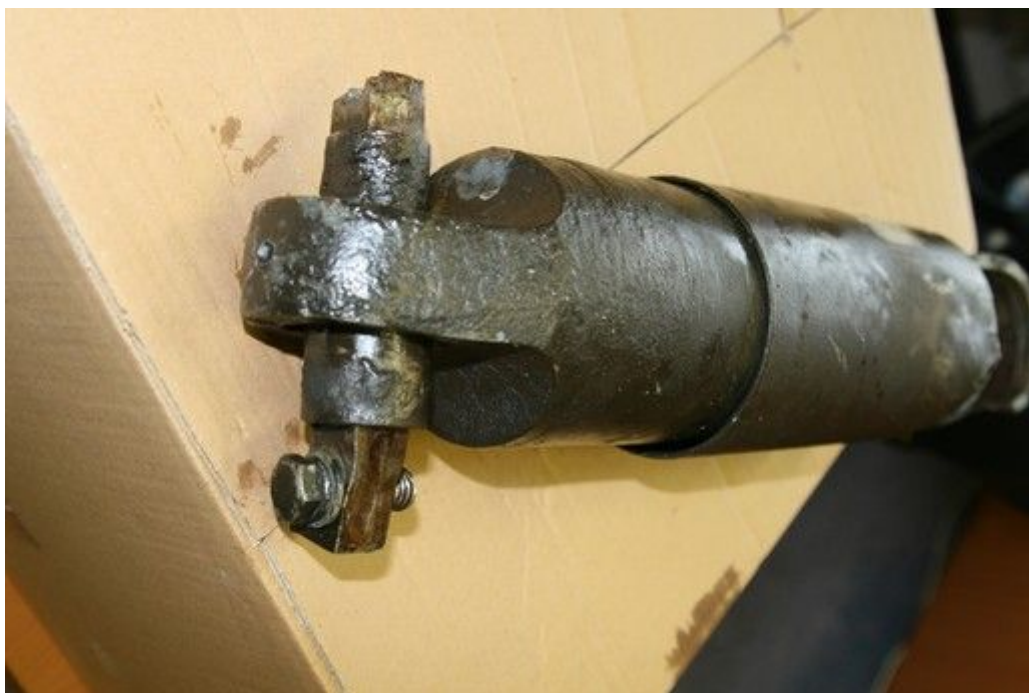
Obr. č. 9: Poškozený dolní nosič tlumiče sekundárního vypružení Zdroj: Drážní inspekce
