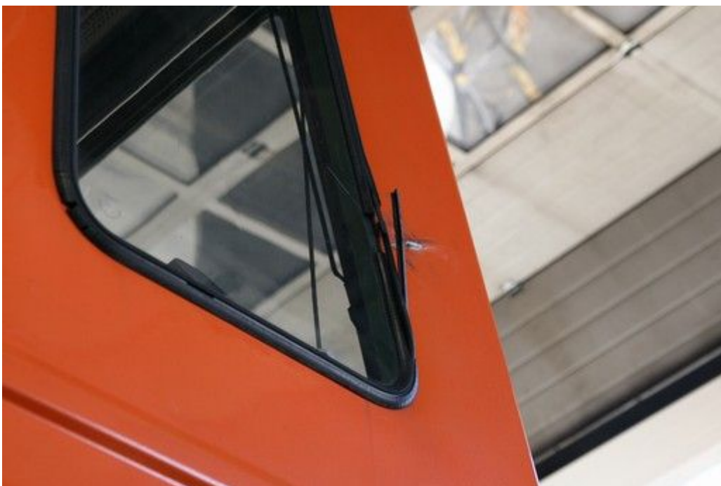
Obr. č. 13: Poškození okna 2. stanoviště strojvedoucího HDV 91 54 362 021-8 vlaku R 685
