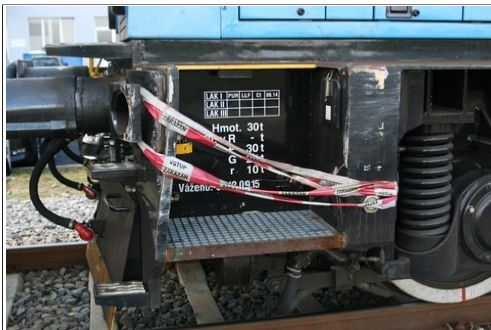
Obr. č. 1: Detail poškozeného čelníku na straně dlouhého představku a levé stupačky (schůdku) HDV CZ-VUZ 98 54 4 794 001-8 .
