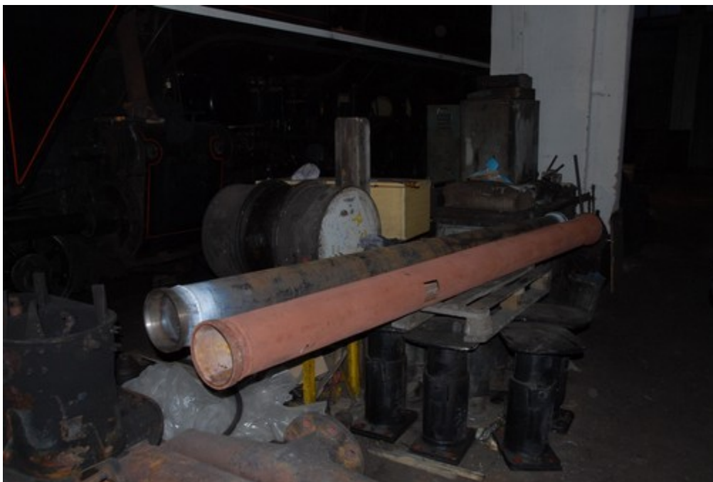
Obr. č. 11: Pohled na poškozenou přítokovou rouru parní lokomotivy 475.111, kdy je poškozené místo vyříznuto
