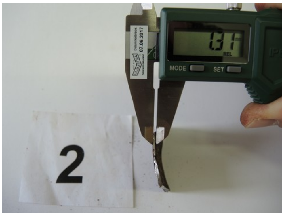
Obr. č. 10: Vzorky materiálu získané z přítokové roury
