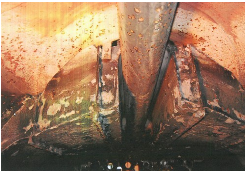
Obr. č. 14: Vnitřní povrch lokomotivního kotle v době na začátku jeho opravy
