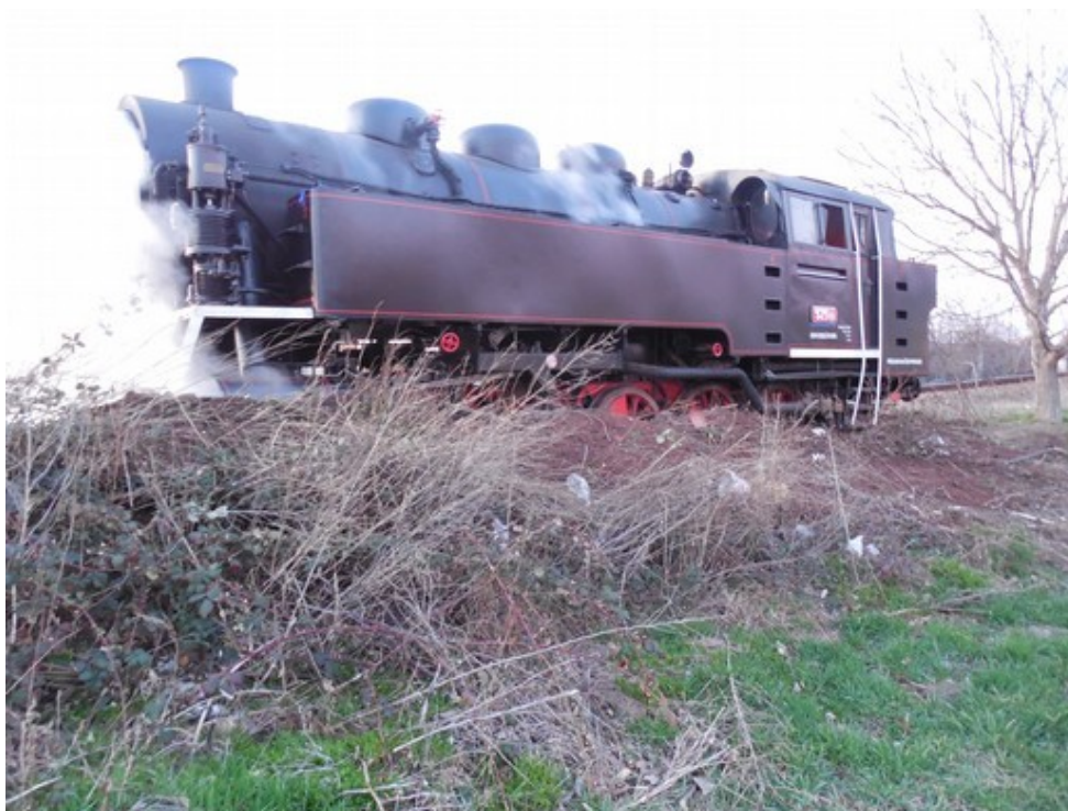
Obr. č. 15: Pohled na vykolejenou parní lokomotivu po vzniku MU
