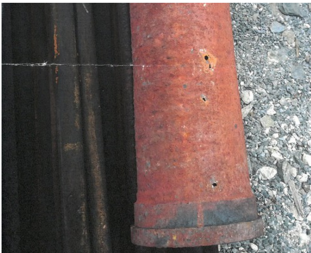
Obr. č. 13: Pohled na poškozenou přítokovou rouru parní lokomotivy 475.101
