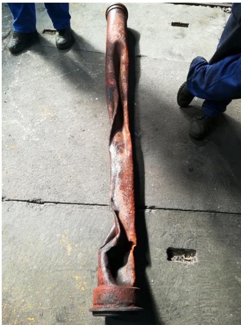
Obr. č. 8: Stav přítokové roury po jejím demontování z lokomotivního kotle
