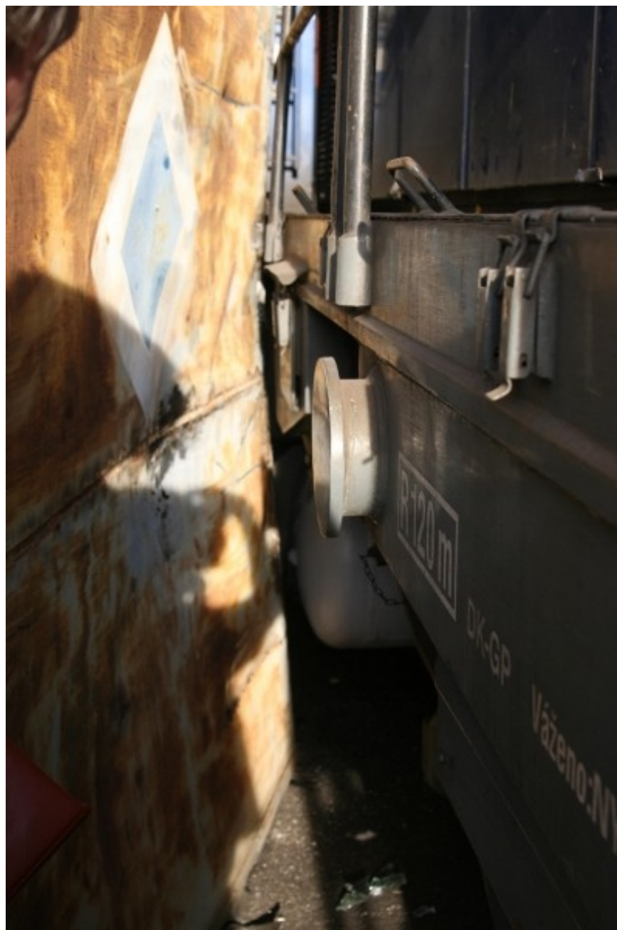
Foto 2: Detail prolomených vrat doléhajících k boku HDV.
