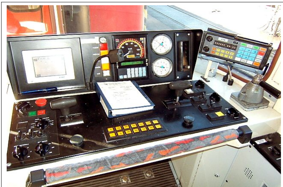
Foto 2: Stanoviště strojvedoucího vlaku Os 4813, které není vybaveno ovládacím prvkem k deaktivaci automatického hlášení palubního informačního systému
