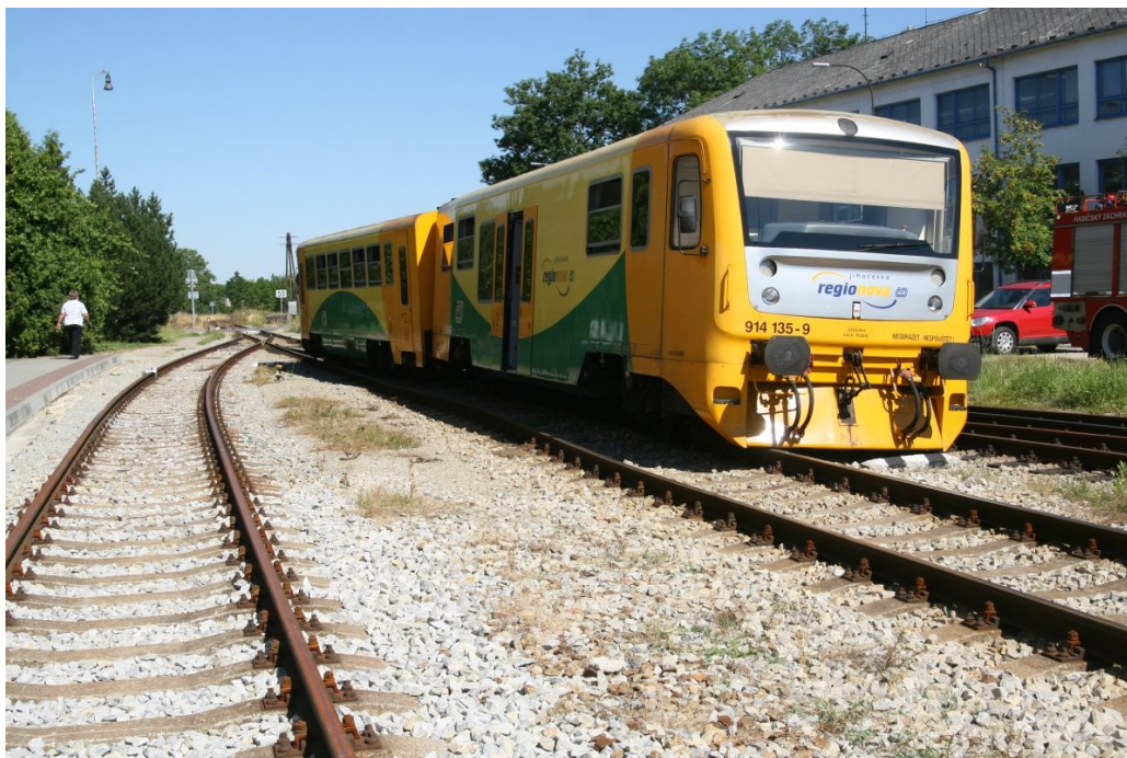
Obr. č. 3: Vykolejená souprava
