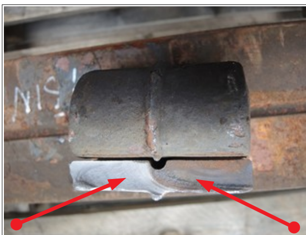
Obr. č. 5: Pohled na lomovou plochu hlavního listu pružnice.
