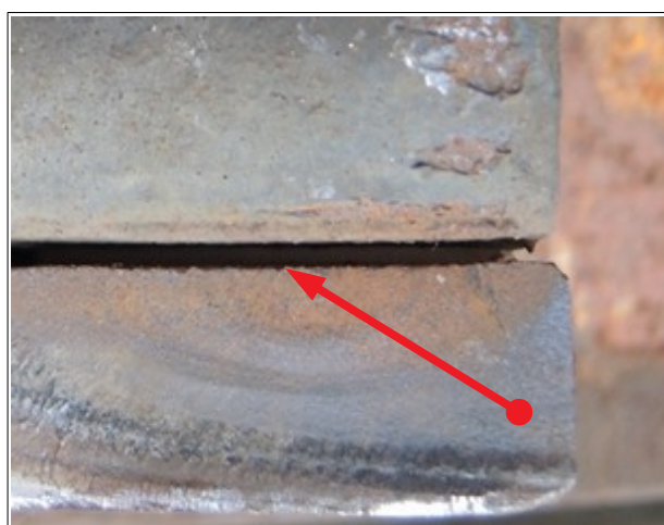
Obr. č. 6: Detail místa iniciace lomu hlavního listu pružnice.
