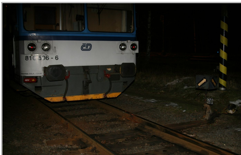
Obr. č. 1: HDV 810.506-6 v konečném postavení po MU na VK č. 17b, v km 37,631, na dráze-vlečce „Vlečka DKV Olomouc, PP Vsetín“.
