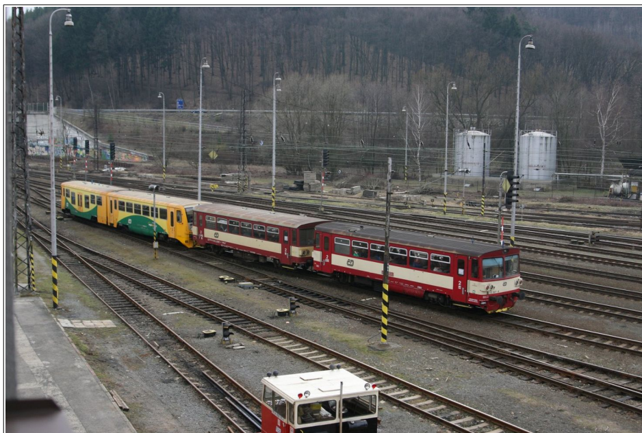
Obr. č. 2: Vlak Os 13272 byl sestaven z HDV řady 810, TDV řady BDtax 782 a motorové jednotky „Regionova. Snímek dokumentuje obdobně řazený vlak vjíždějí do žst. Vsetín ze směru od dopravní D3 Velké Karlovice.
