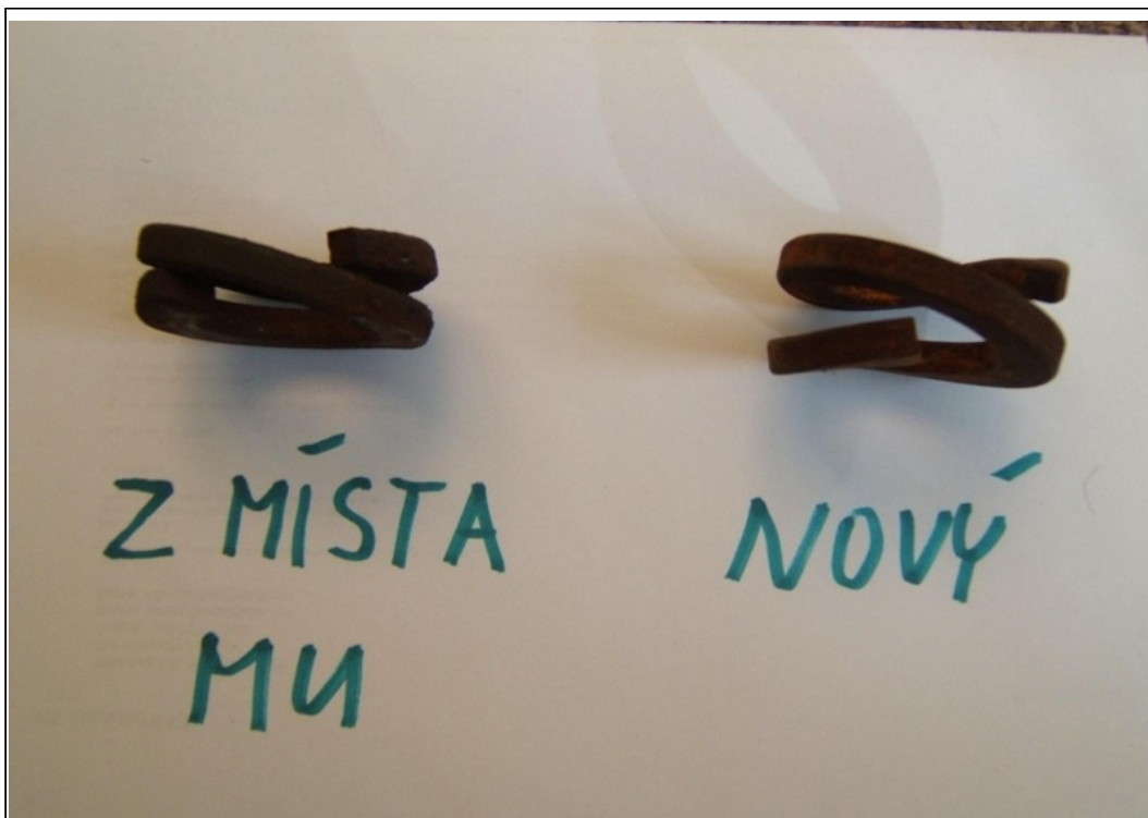
Obr. č. 5: porovnání stavu pružných dvojitých kroužků z místa MU a nového kusu.
