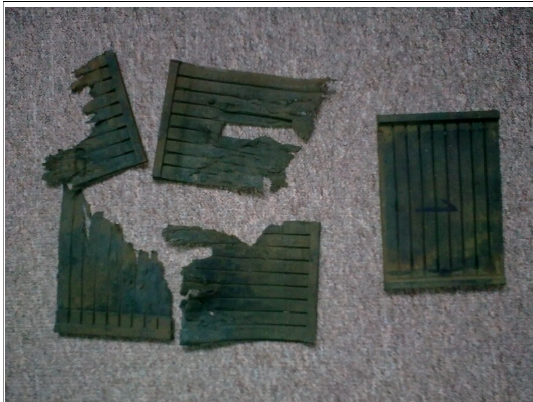
Obr. č. 4: pryžové podložky pod patu kolejnice, vlevo 4 ks z místa MU, vpravo zánovní kus.
