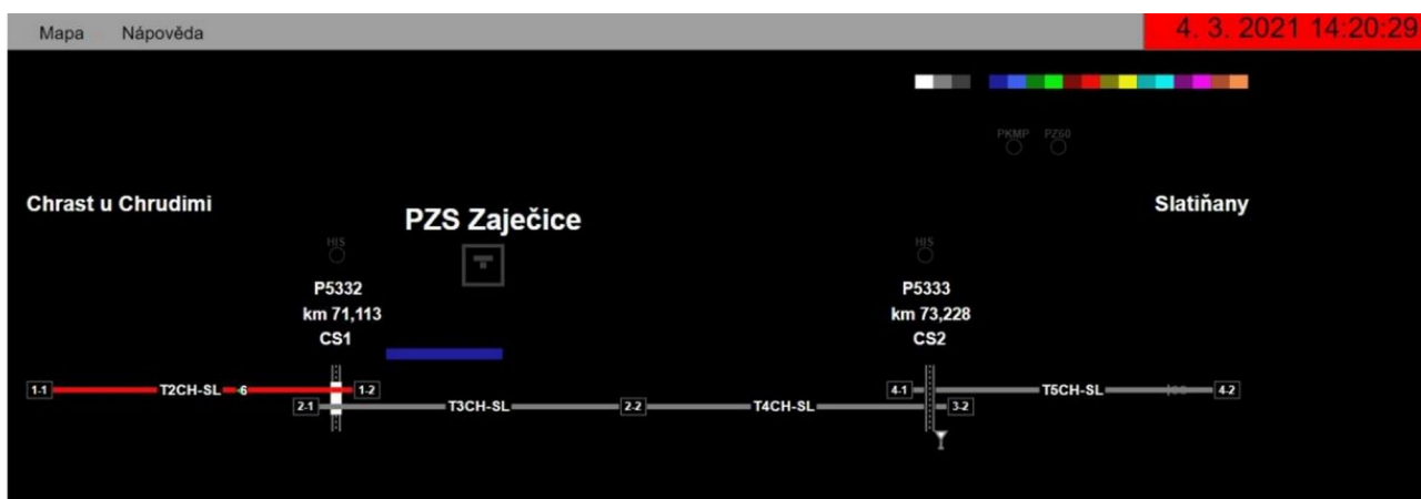
Obr. č. 2: Ukončení výstrahy PZZ na ŽP P5332
