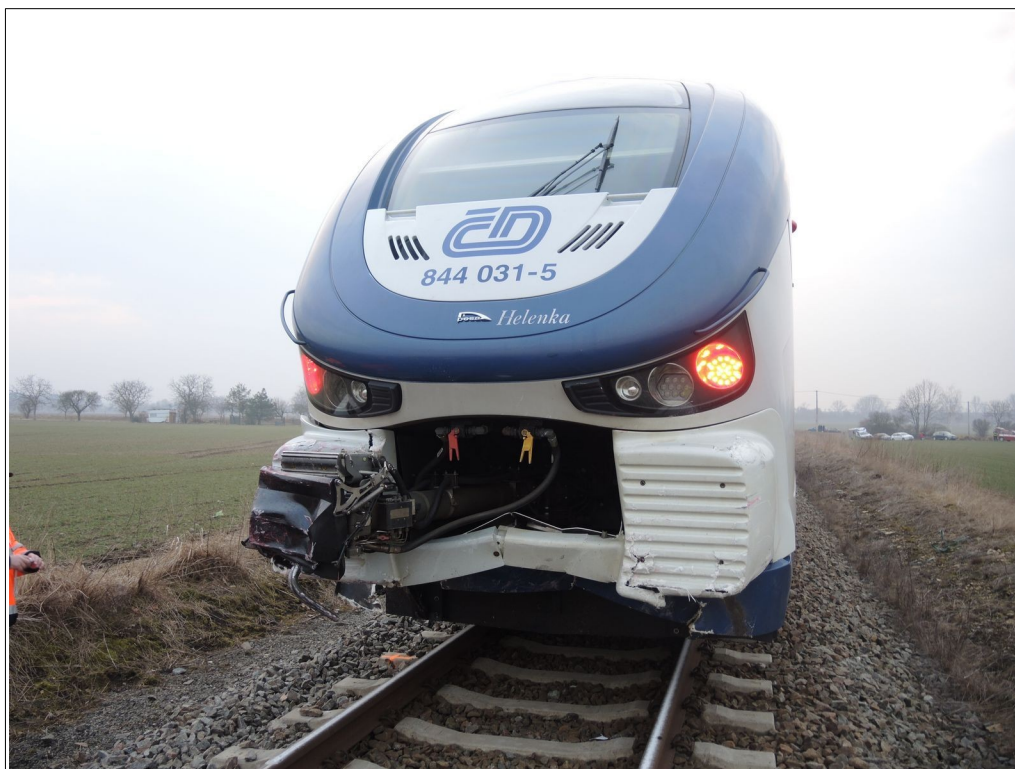
Obr. č. 3: Poškozené čelo HDV
