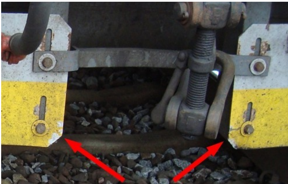
Obr. č. 21: Pohled na čerstvé stopy na pluhu HDV řady 350 zdokumentované po MU Zdroj: SŽDC
