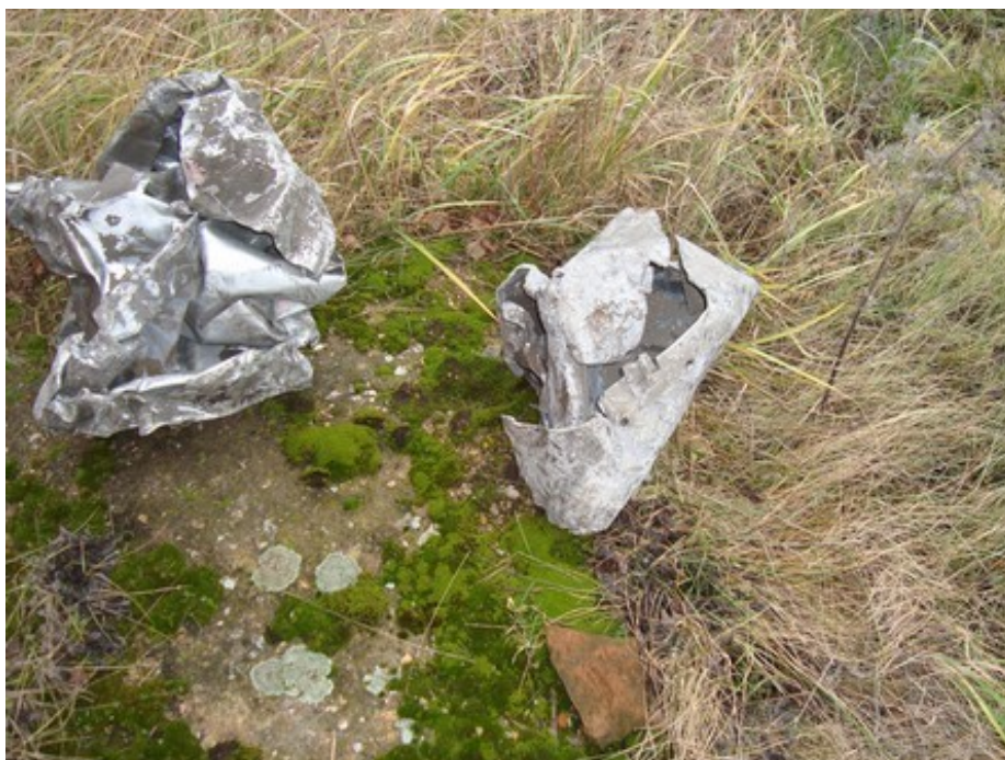
Obr. č. 23: Pohled na deformovaný kryt EO (vpravo) a hliníkový plech z vozu (vlevo)
