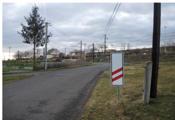
Obr. č. 6: Svislá dopravní značka A 31b „Návěstní deska“ (160 m) Zdroj: DI
