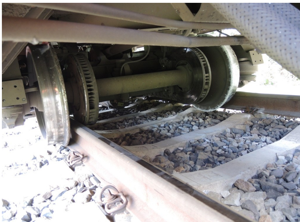
Obr. č. 1: Pohled na vykolejený druhý podvozek řídicího vozu po vzniku MU
