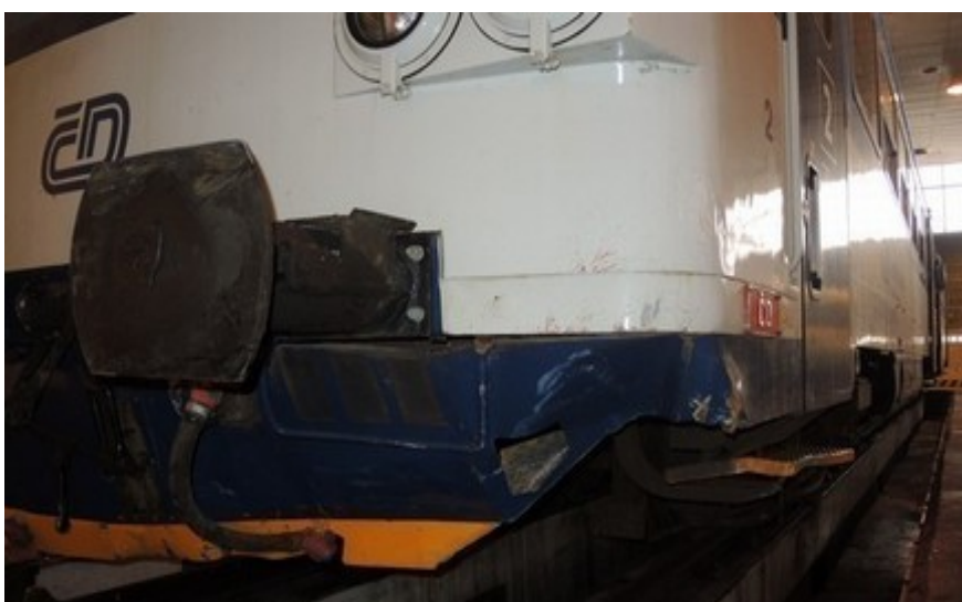
Obr. č. 4: Poškození levé strany HDV
