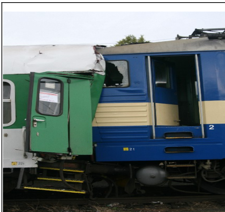
Foto 3: Pohled na destrukci stanoviště II HDV 362.171-1 a čelo TDV 51 54 20-41 843-3 z koleje č. 511
