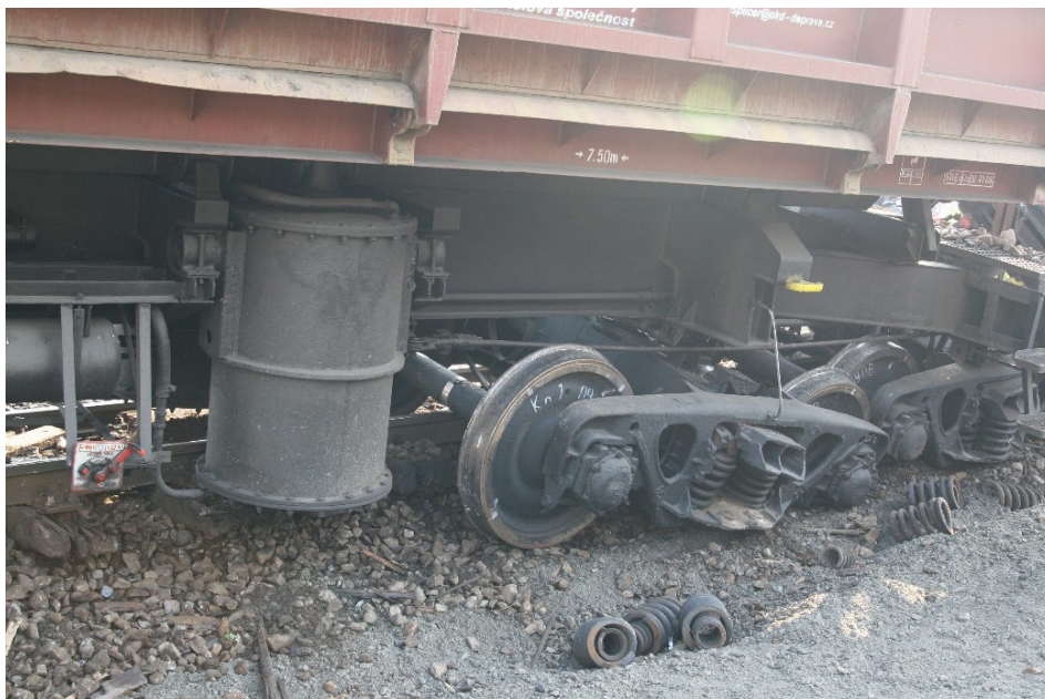
Foto 3: Pohled na vykolejené a poškozené DV
