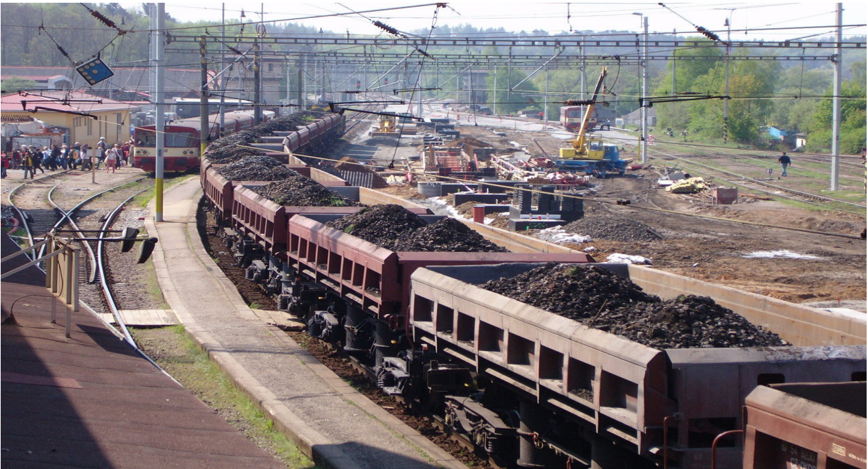
Pohled na nerovnoměrné, jednostranné naložení nákladu (přepravovaného štěrku), vzhledem k podélné ose DV řad Ua a Uas vlaku 1. nsl Pn 69911
