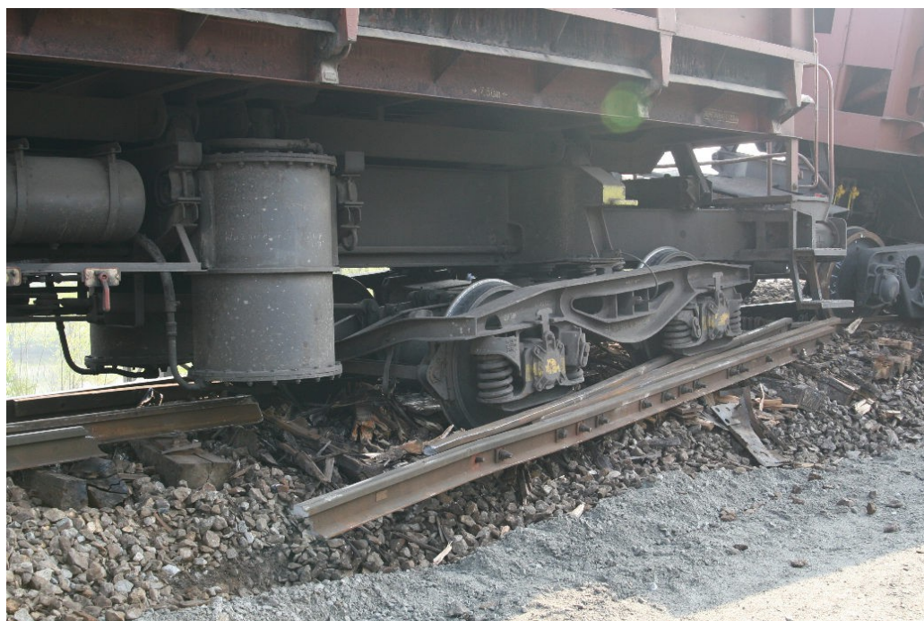
Foto 2: Pohled na poškozenou výhybku
