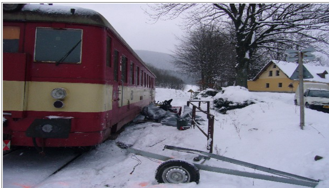
Obr. č. 2 Pohled na torzo částí přívěsného vozíku po MU (Foto RIBŽD Praha)
