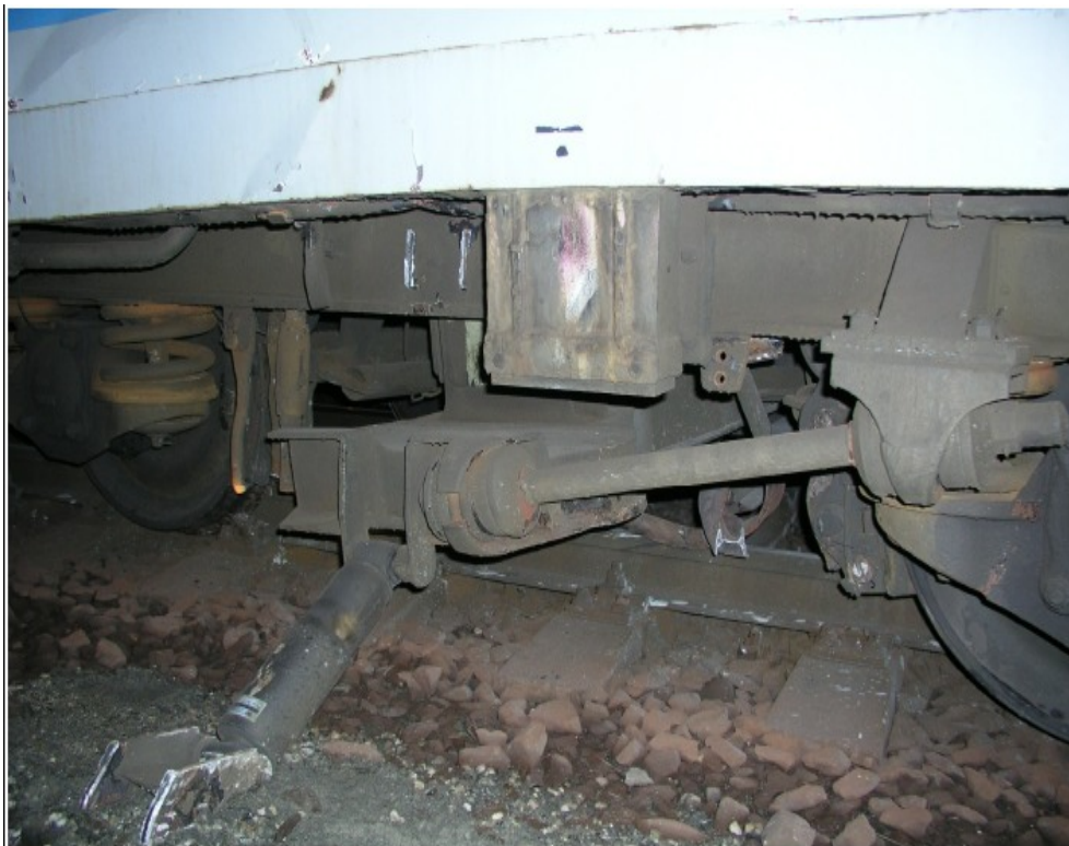
Vykolejený podvozek taženého drážního vozidla 063.321-4 závěsy sekundárního vypružení
