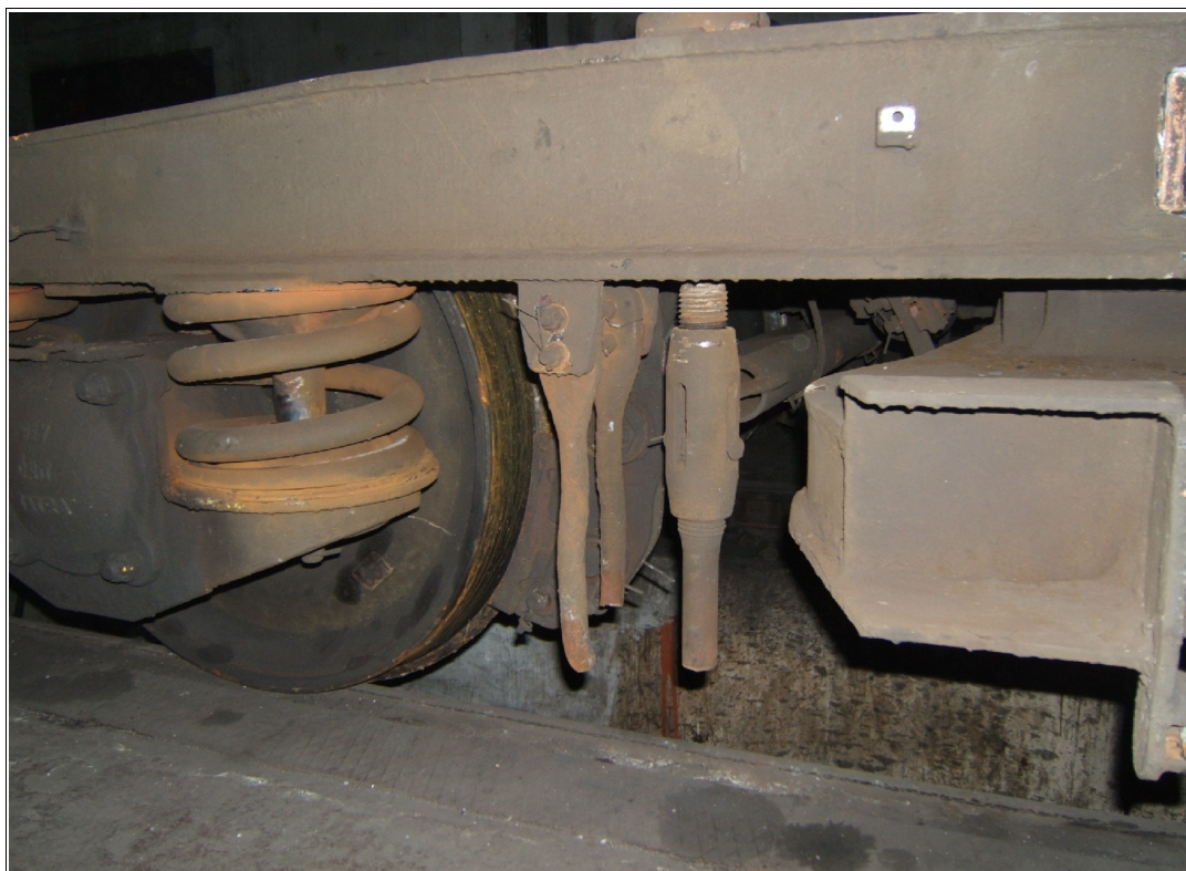
Foto č. 1: Pohled na ulomenou část spodního závěsu a ulomený závěs
