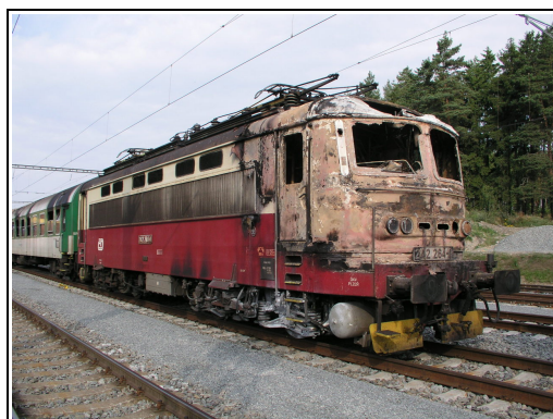
Foto 1: Pohled na hnací drážní vozidlo po požáru
