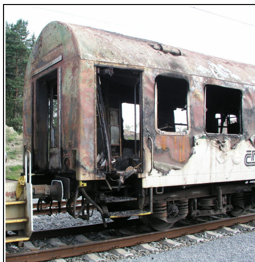
Foto 2: Pohled na tažené drážní vozidlo po požáru
