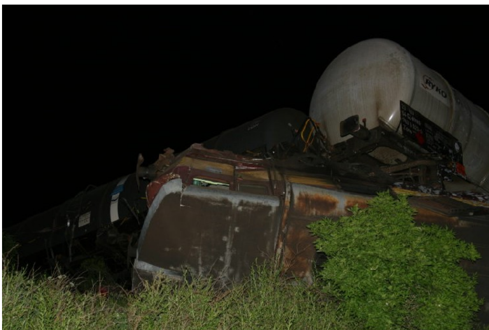
Foto 7.4: Vykolejené vlakové HDV 751.092-8 a první dvě tažená DV bezprostředně po vzniku MU z levé strany ve směru jízdy vlaku.
